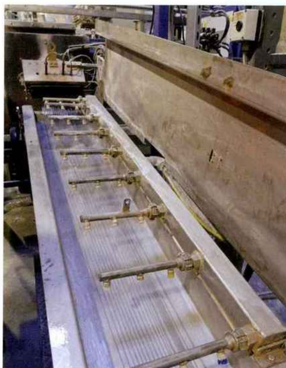
3. Couverture relevée, les fils gris sont du PET extrudé.
