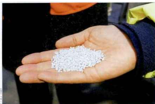
4. Voici les granules de PET avant la polycondensation qui épure à la qualité alimentaire.
