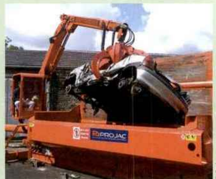
La presse à VHU permet d'optimiser leur stockage puis leur transport vers les sites de broyage.
