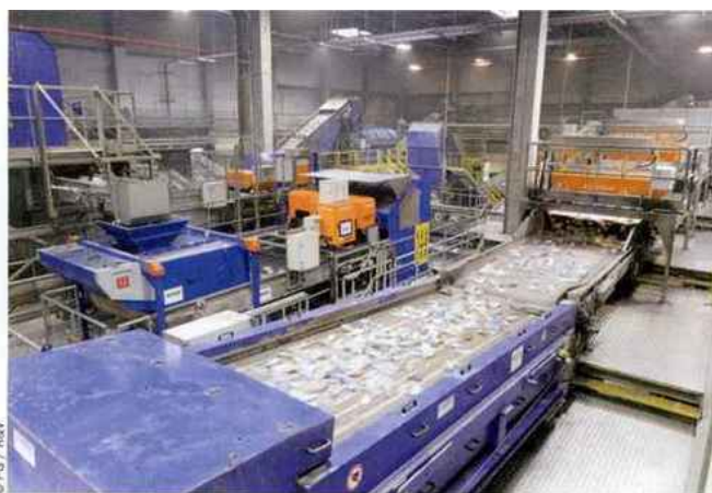
1. Dans un premier hall, les balles sont ouvertes et épurées des matières intruses qui ne correspondent pas à des bouteilles en PET, polyéthylène téréphtalate. Plusieurs trieuses optiques sont utilisées, des fabricants Tomra et Pellenc ST.
