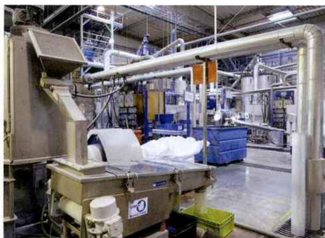
2. Le deuxième hall ressemble à un univers chimique. On y transforme les particules des bouteilles en granules de PET de qualité alimentaire.
