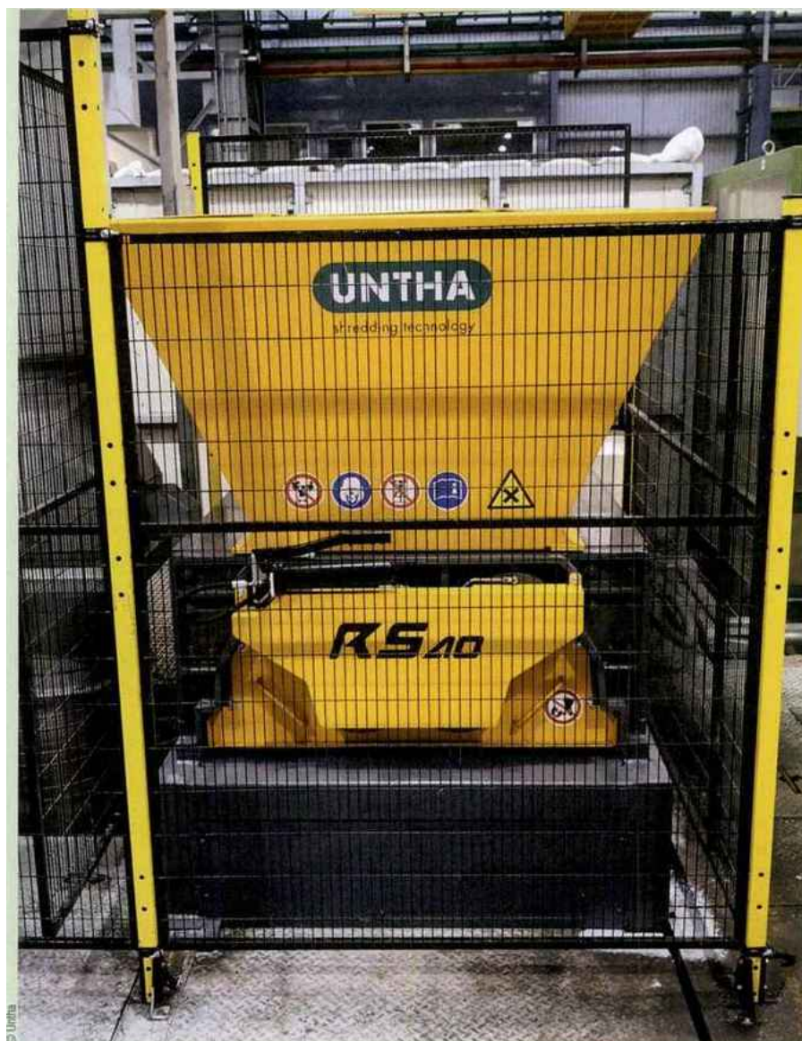
Le déchiquetage des chutes métalliques sur leur site de production permet d'obtenir une ferraille d'excellente qualité très prisée des fonderies.
