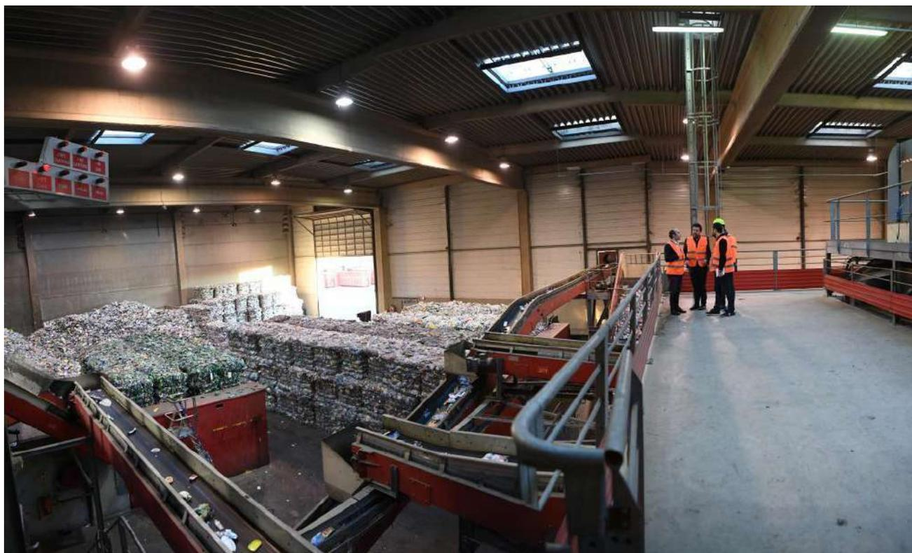
L'aile dédiée au plastique a cumulé 4.000 tonnes de matière en 2019. Embarqués sur un dédale de tapis roulants, ces emballages sont extraits du reste du flux puis isolés au fil d'un process automatisé très pointu – comprenant notamment des trieurs optiques – avant de défiler entre les mains expertes des « valoristes ».
