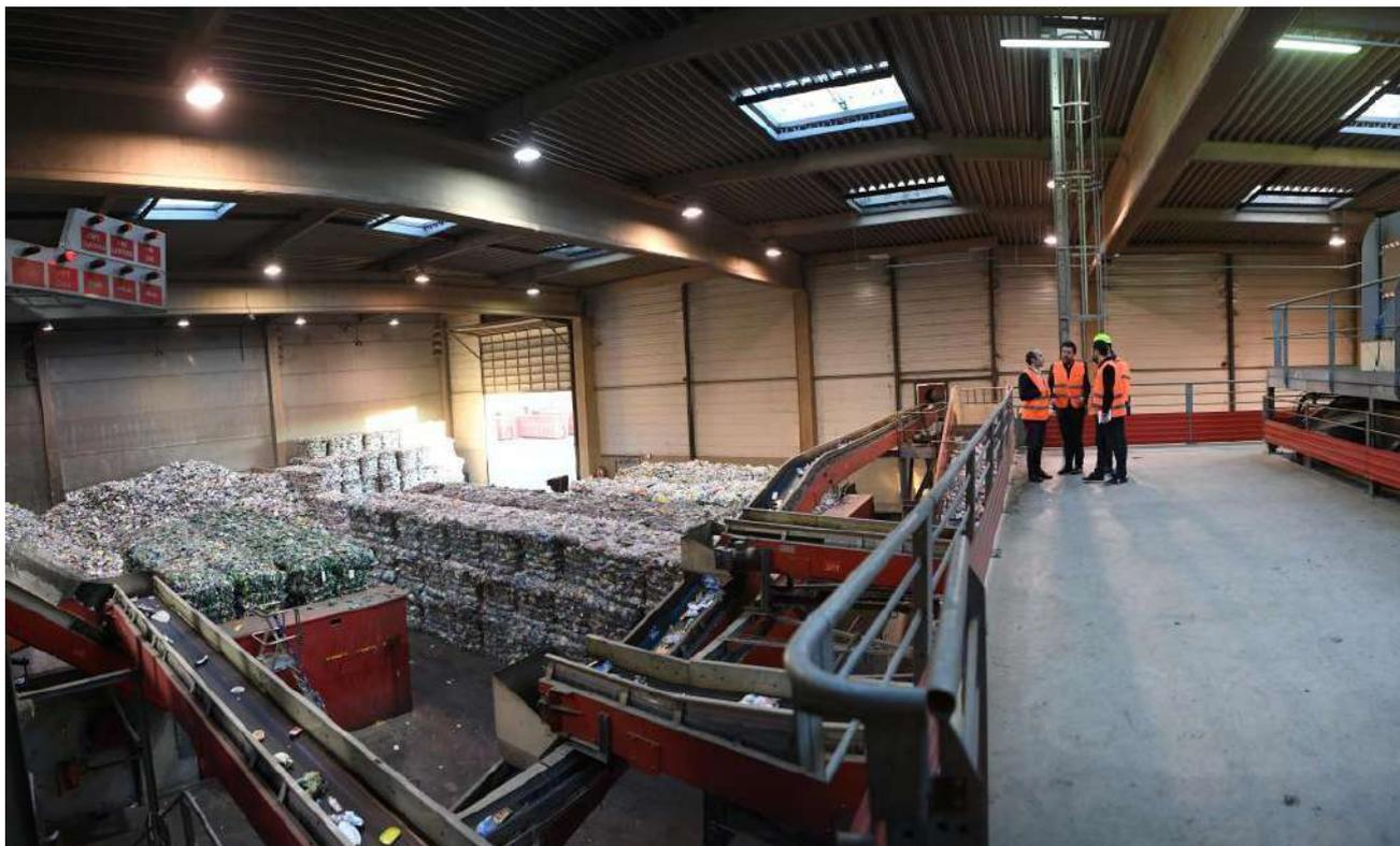
L'aile dédiée au plastique a cumulé 4.000 tonnes de matière en 2019. Embarqués sur un dédale de tapis roulants, ces emballages sont extraits du reste du flux puis isolés au fil d'un process automatisé très pointu – comprenant notamment des trieurs optiques – avant de défilé entre les mains expertes des « valoristes ».
